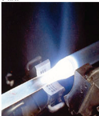
Рис. 3.5. Процесс остекловывания в методе осаждения из газовой фазы
